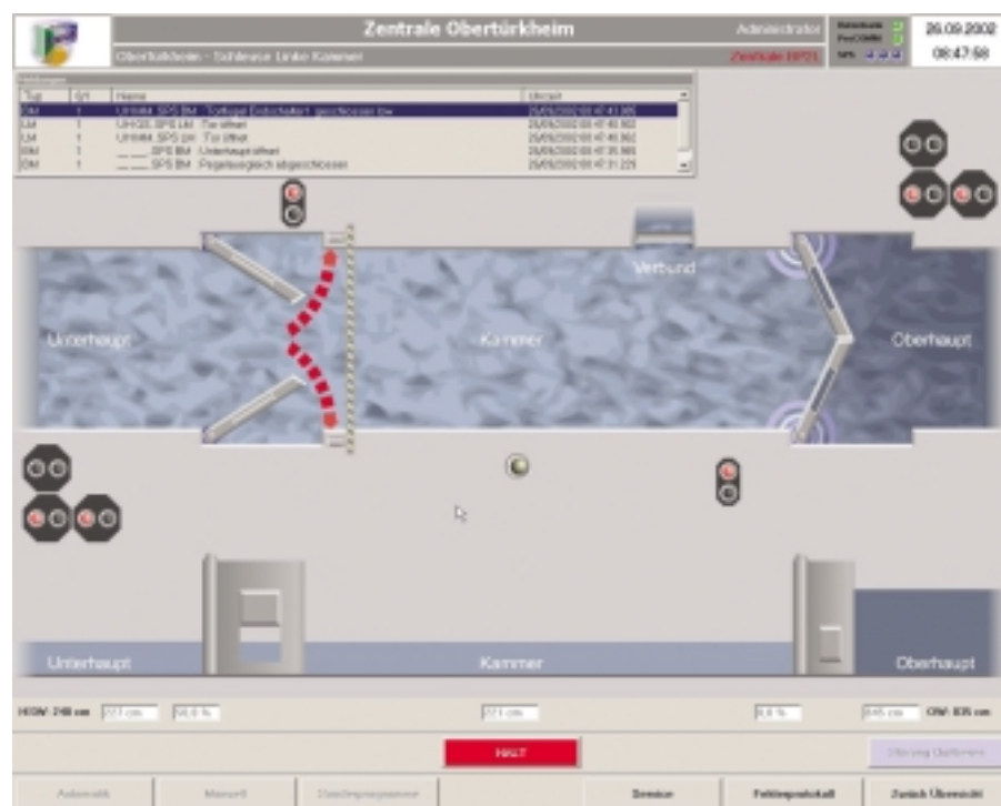
Visualisierungsoberfläche einer Schleuse in FINION
